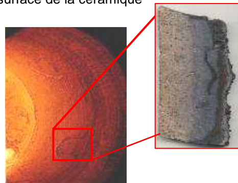
Fig. 6 : Imprégnation et écaillage de réfractaires dans une poche à acier
